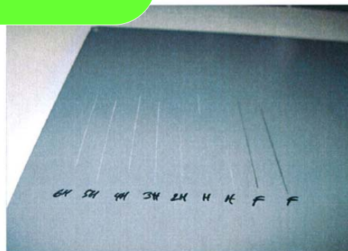
Testergebnis Stifthärte an Lackierung FA80; Keine Beschädigung der Lackoberfläche ab Härtegrad „F“
