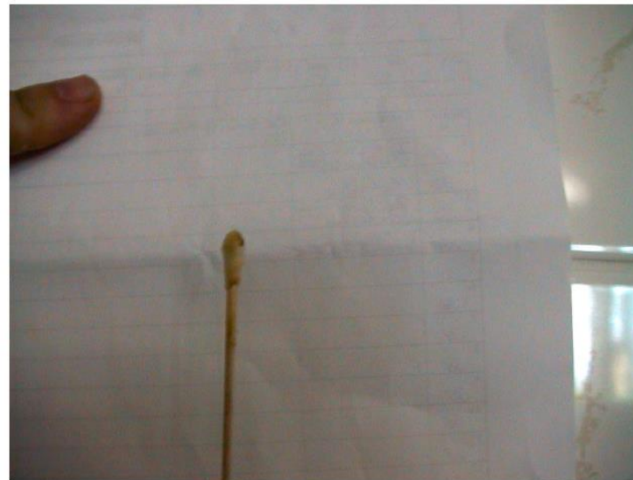
Abb. 11 Aufnahme des normalerweise weißen Abstrichtupfers, mit welchem ein Abstrich aus dem Inneren des Anschlussteiles (siehe auch Abb. 10) genommen wurde. Der Abstrichtupfer ist voll mit schmierigem Belag (Biofilm)
