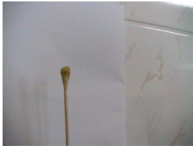
Abb. 13 Aufnahme des normalerweise weißen Abstrichtupfers aus dem Schlauchstück (siehe auch Abb. 12) mit schmierigem Belag (Biofilm)
