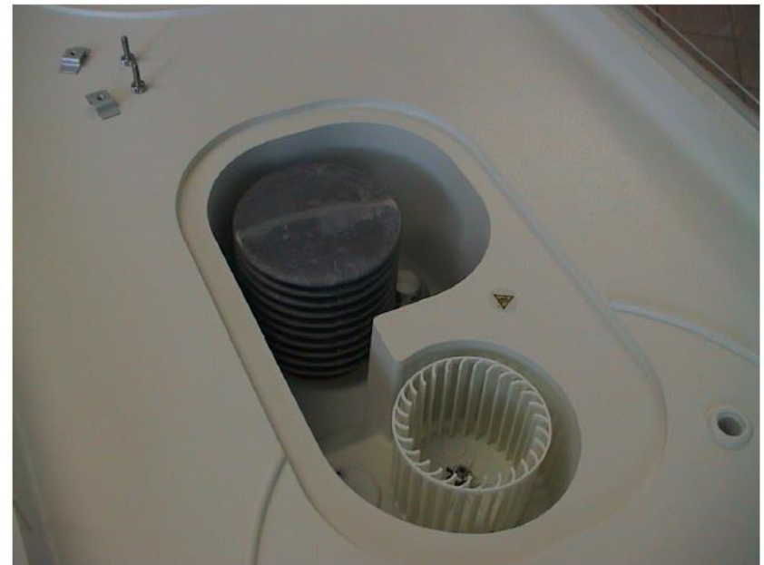
Abb. 14 Aufnahme der Wanne mit Heizaggregat und Ventilator, wohin das Schlauchstück (siehe auch Abb. 12) führt
